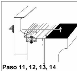
**Paso 13.** Introduzca los clavos de concreto en la viga de unión a una distancia de 7" y 5" de la loseta. El clavo debe clavarse en la viga de unión solo hasta la mitad.
