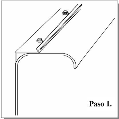
**Paso 1.** Coloque la plomada nivelada en el borde de la pared. Utilice (100) tornillos para sujetar la tira. Fije la tira con tornillos autorroscantes cada 8". Atornille las tiras con fuerza, ya que se verán una vez que se complete el trabajo.
