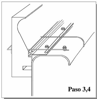
*Nota: Los alambres de unión se pueden sujetar de dos maneras. Se pueden envolver alrededor del borde posterior de la pared o puede usar los otros (100) tornillos autorroscantes. Para usar los tornillos, simplemente fíjelos 4" detrás de la plomada (solo hasta la mitad y envuelva la cola del alambre de amarre alrededor de ellos).*
