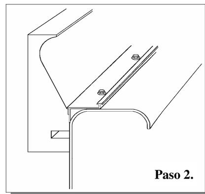
*Nota: Los alambres de unión se pueden sujetar de dos maneras. Se pueden envolver alrededor del borde posterior de la pared o puede usar los otros (100) tornillos autorroscantes. Para usar los tornillos, simplemente fíjelos 4" detrás de la plomada (solo hasta la mitad y envuelva la cola del alambre de amarre alrededor de ellos.*
