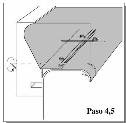
**Paso 3.** Empuje el alambre de amarre a través de la forma, incluso con la parte superior de la plomada. Envuelva el extremo del alambre de amarre alrededor del borde posterior de la pared o el tornillo, aplicando una ligera presión.
