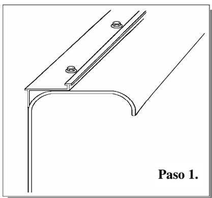
**Paso 1.** Coloque la plomada nivelada en el borde de la pared. Utilice tornillos para sujetar la tira. Asegúrese de unir las juntas bien juntas ya que la tira será visible en el producto terminado.
